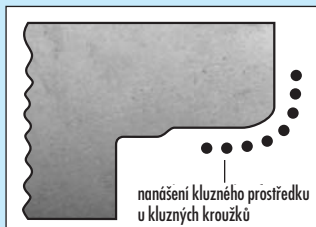
nanášení kluzného prostředku u integrovaného těsnění
