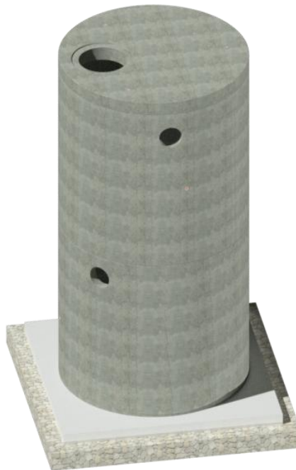
Obr. č. 11 osazení zákrytové desky
