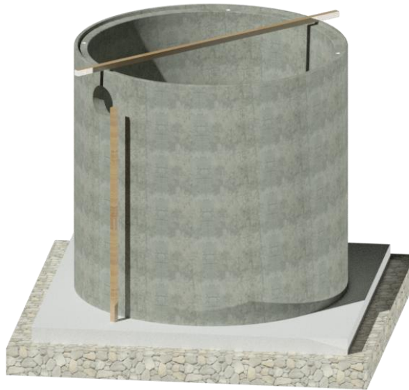
Obr. č. 1 kontrola rovinatosti uloženého dna
