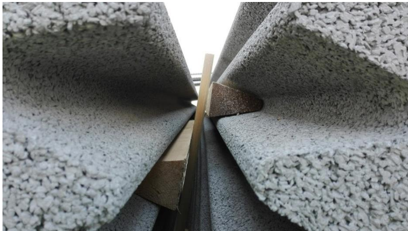
Obr. č. 2 Proložení panelů ve stojanu mezi sebou pomocí prokladů kopírujících tvar vlny.
