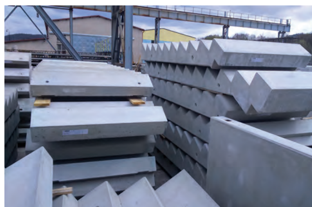
Bydlení nad Přehradou - P10 - Horní Měcholupy schodišťová ramena
